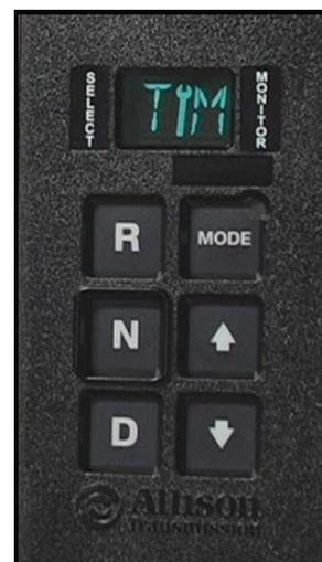
(\*) .... Uvedený popis se vztahuje na tlačítkové voliče. U pákového voliče jsou postup a počty stisknutí stejné, jenom se místo současného mačkání šipek mačká speciální diagnostické tlačítko.
