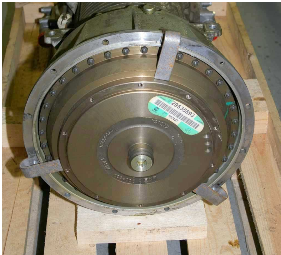
Zajištění měniče ke komoře originálními držáky Allison tvaru J
