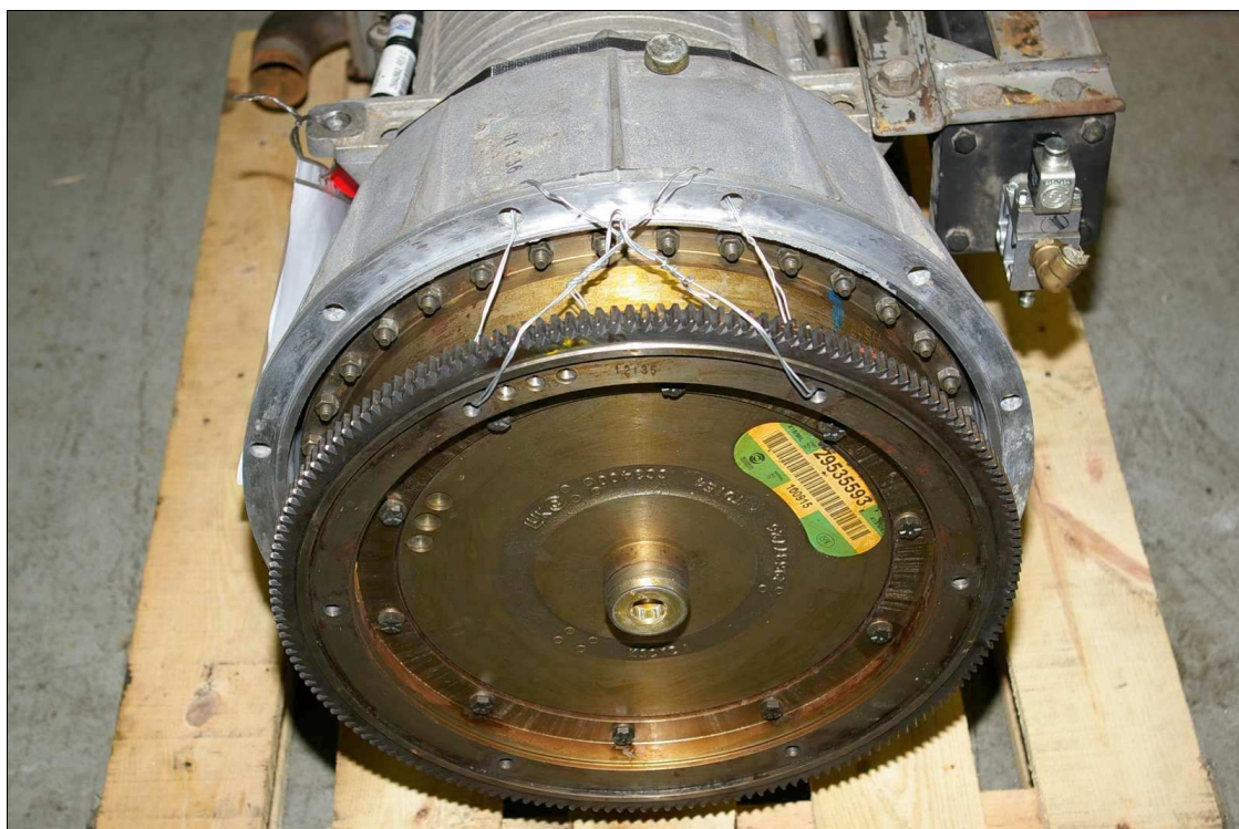
Příklad provizorního zajištění měniče ke komoře drátem, měnič nastavte výškově do střední polohy
